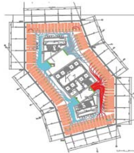
Grundriss mit thermoaktiven Deckenpaneelen und Anschlussleitungen
